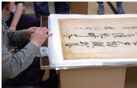
写真 16 塩分濃度測定
